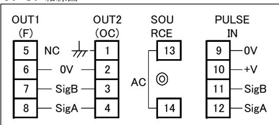
結線終了後、ねじの緩みや誤配線がなく確実に接続している事を確認して下さい。
